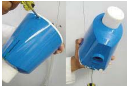
1.) Desatornillar el tornillo en la parte superior e inferior del DosaMAX Jr. para remover la tapa
