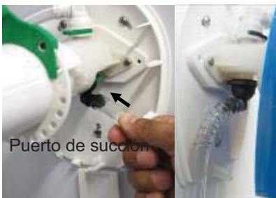
5.) Conectar manguera de succión con resorte al Puerto de entrada.
