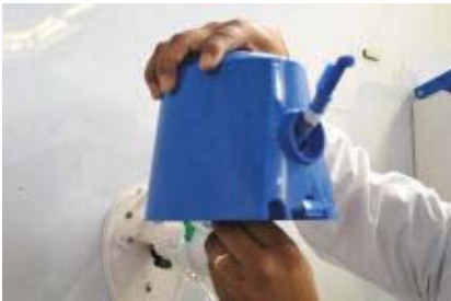
1.) Recorra la manguera de descarga con boquilla por la parte de abajo de la tapa
